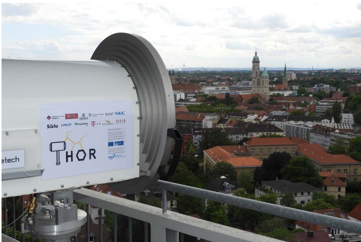
図2：ブラウンシュヴァイク工科大学構内建物屋上に設置された世界初の実データ伝送可能な双方向テラヘルツ無線装置 ブラウンシュヴァイク工科大学 Thomas Kürner 教授提供
