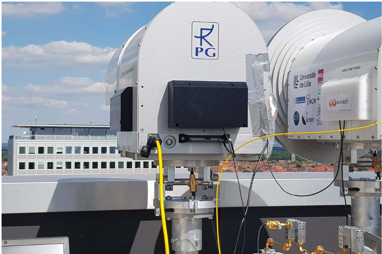
図 1：ブラウンシュヴァイク工科大学構内の Oker Tower と IT センター（距離 160m）を結ぶ無線装置 ブラウンシュヴァイク工科大学 Thomas Kürner 教授提供
